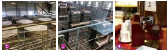
① 志比田工場では1日85トンの黄金千貫(こがねせんがん)を使用。南九州の約1900軒の農家の協力があってこそ② 麹を仕込むための米は1日17トン。米:芋=1:5の割合で使用③ 蒸溜はオリジナルの「構型蒸溜機E-II型」と呼ばれる蒸溜プラントで④ 見学受付のあるブルワリーでは焼酎の試飲もできる
